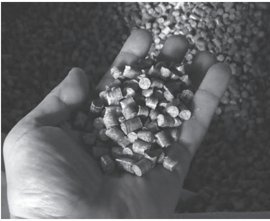
杉残材を粉碎・圧縮したペレット燃料
